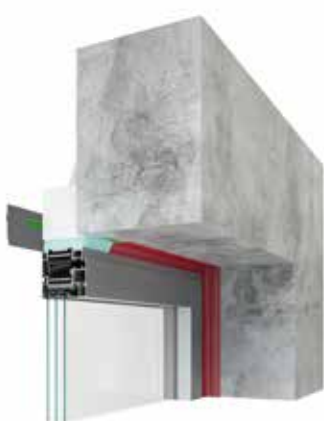
połączenie górne, z taśmą paroszczelną i klejem-uszczelniaczem
