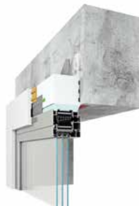
połączenie górne, z zastosowaniem profilu zewnętrznego węgarka
